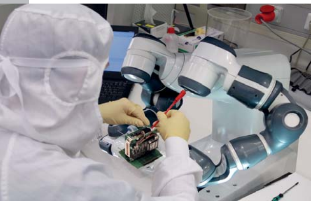
Die enge Kooperation zwischen Mensch und Roboter, um so möglichst effizient die OBDH-Platine eines Kleinsatelliten zu bestücken.
