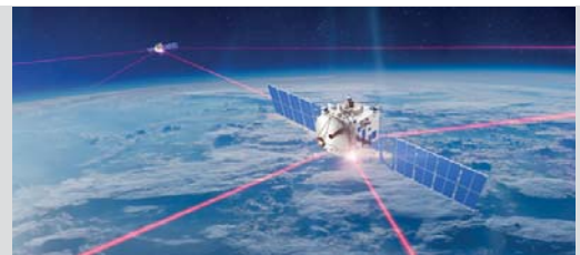
Illustration einer mittels Laserkommunikation vernetzten Satellitenkonstellation.
